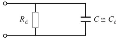
Figure D.15 Schéma équivalent d'une diode polarisée en direct
